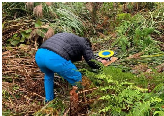
図－3 G N S S 内蔵対空標識設置状況
