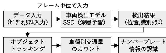
図-1 計測・認識の処理フロー
