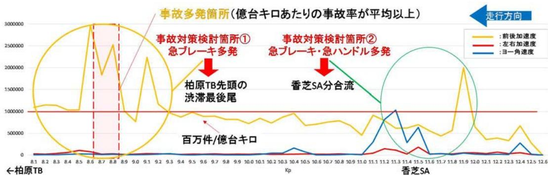
図 1 急挙動の発生件数（西名阪道上り 柏原 IC～香芝 IC 間）
