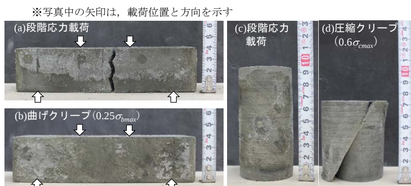
図4 実験後の供試体
