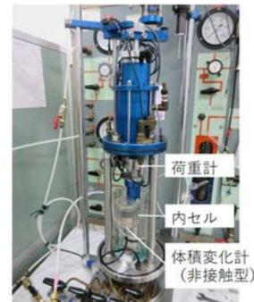
写真-1 繰返し三軸試験機 (三軸室部)
