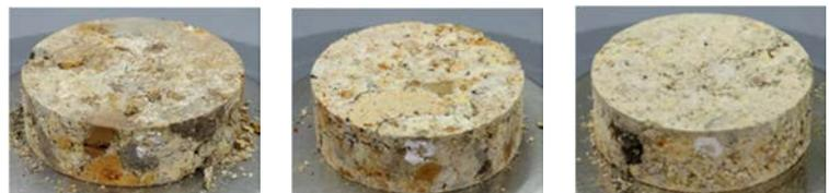
図-1 乾燥後の不攪乱試料の供試体
