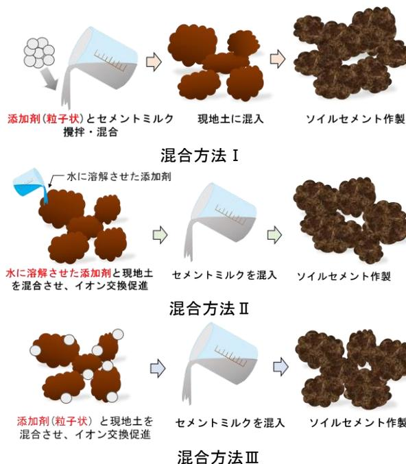
図-1 混合手順(混合方法I~III)
