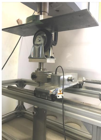
写真-3. 浮き上がり防止の治具
