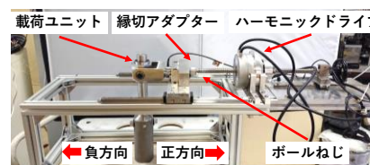
写真-2. 水平載荷装置
