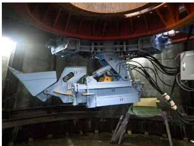
写真-1 天井走行式ケーソンショベル
