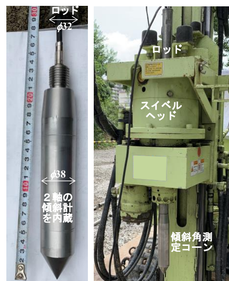
写真-1 傾斜角測定コーンと設置状況
