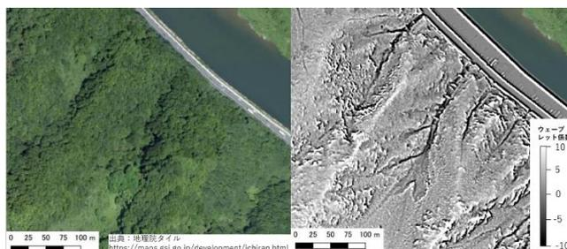
図-1 空中写真とウェーブレット解析図の比較
