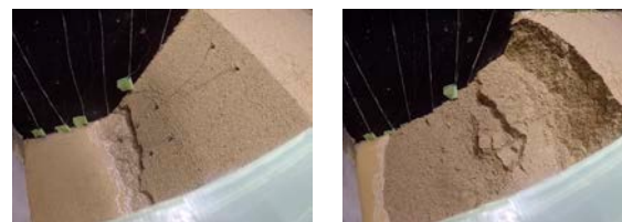
図 2 遠心模型実験の崩壊の様子
