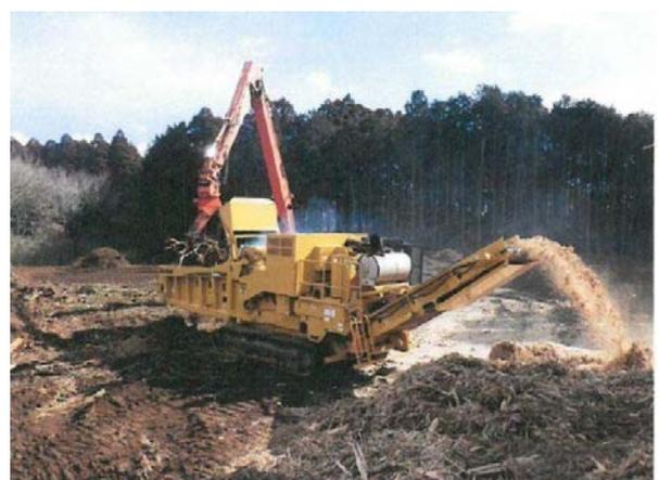
写真-1 破碎機によるチップ化状況
