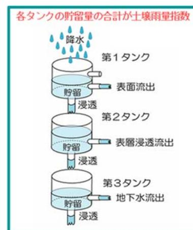
図1 土壌雨量指数の概念図<sup>1)</sup>
