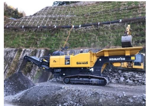
写真-3 母材粒径調整（移動式破砕機）
