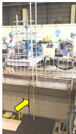
(1) 全景(移動台車上のジャッキで貫入) (2) 拡大(ロッドから先端部分)
