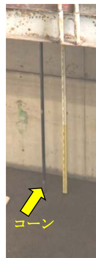
(1) 全景(移動台車上のジャッキで貫入) (2) 拡大(ロッドから先端部分)
