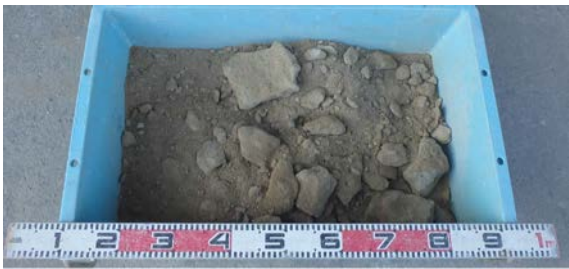
写真 1 粒度調整前の固化改良土
