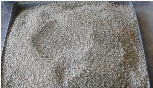
写真 2 粒度調整後の固化改良土
