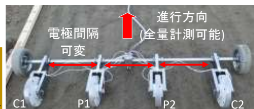
図-5 車輪型電極
