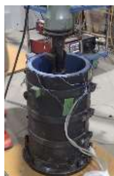
図-2 SH内部への試料の締め固め
