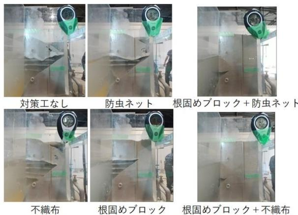
写真-1 各対策工の実験終了後の洗掘状況（断面写真）
