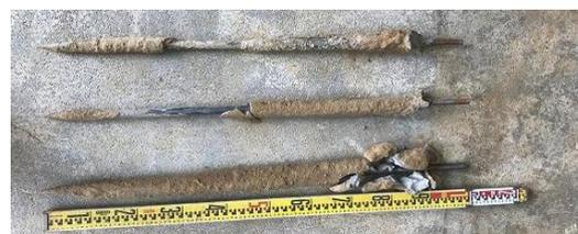
写真-2 掘り起こした補強材 (ケース 0-3G)
