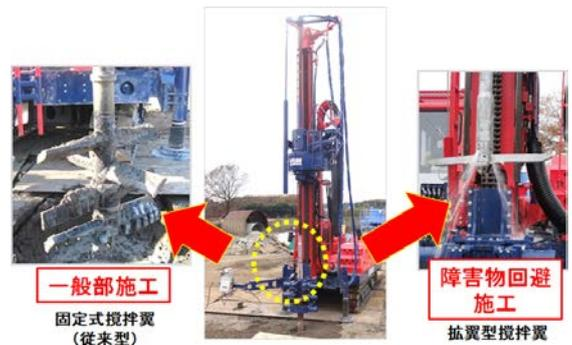
図-3 汎用地盤改良機及び攪拌翼の切替え
