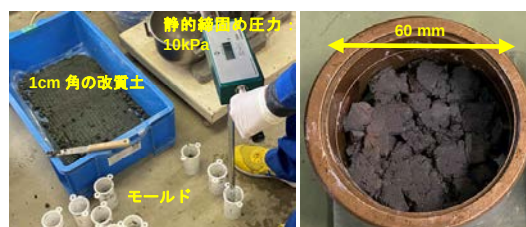
写真-1 再構成状況 写真-2 改質土の状況
