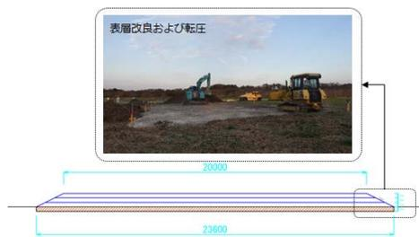
図5 試験盛土断面図
