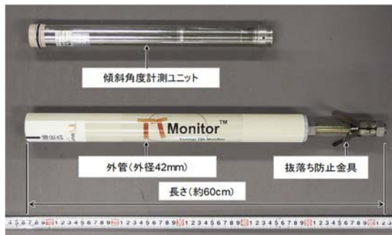
図-2 天端傾斜計
