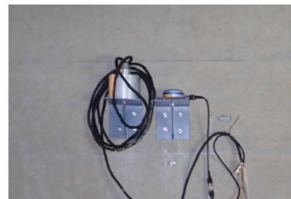
写真-2 振動レベル計, 振動速度計
