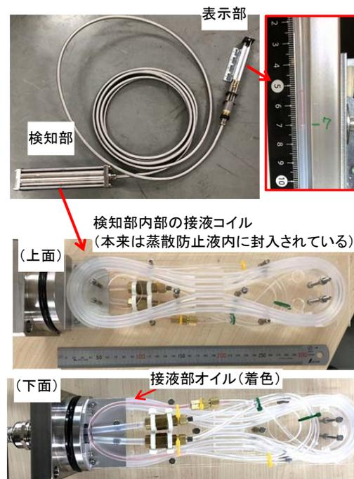
図2 長期安定性対策を施した液柱式インバート変位計測装置
