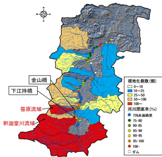
図4 異常出水閉塞率評価と小流域毎の裸地化個数統合化マップ
