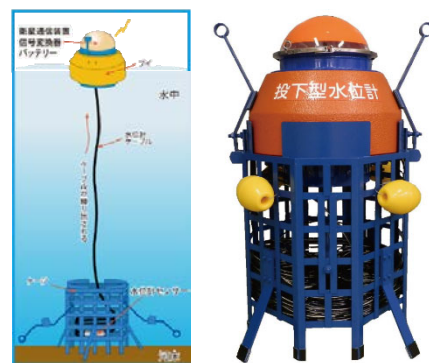
図-1 現行機器（土研式投下型水位観測ブイ）
