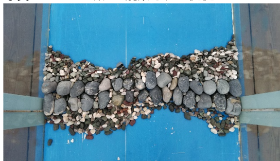
写真 4 1/100 勾配での計測後の状態
