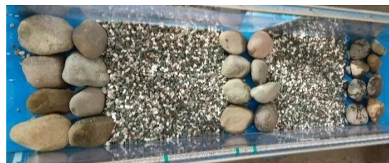
写真2 1/2スケールで石組みを設置した状態
