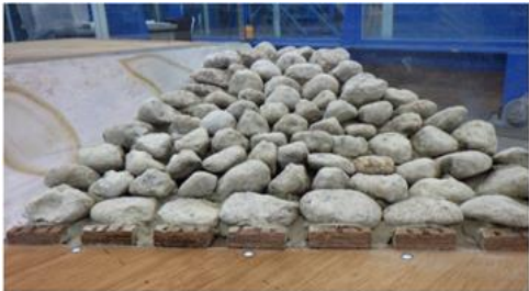
写真 1 石組み下流端に設置した Stopper Block
