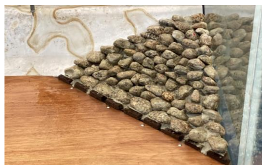
写真2 転石衝突後の石組み
