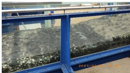
写真2 流量 76.9 m<sup>3</sup>/s 時の流況 (左: 下部の流況, 右: 上部の流況)
