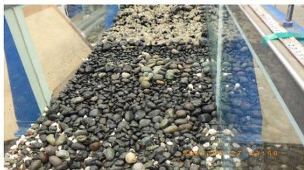
写真1 粗礫斜路の設置状態
