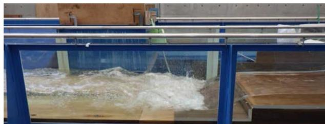
写真 2 跳水式減勢工の流況
