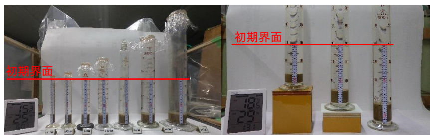
図-5 最終沈降状況 (異径)
