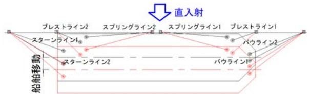
図-1 係留索配置図 (風)
