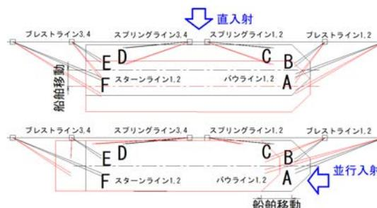
図-4 係留索配置図 (津波)
