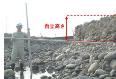
図-5 通水後の河岸 (W15断面)
