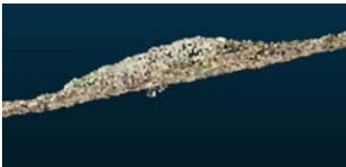
写真-5 写真測量(SfM)による点群データ
