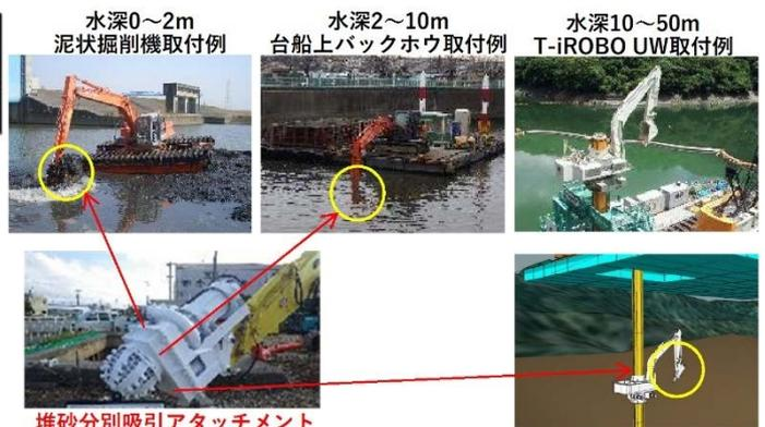
図-6 水深に適応したベース機への装着例
