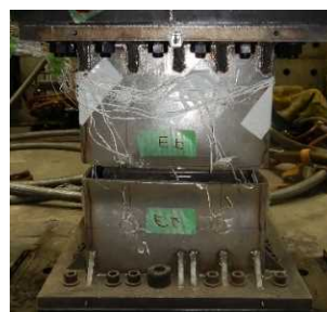
図-7 切断後の可換部
