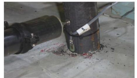
図 6 荷重終了時の状況（鋼棒 B）
