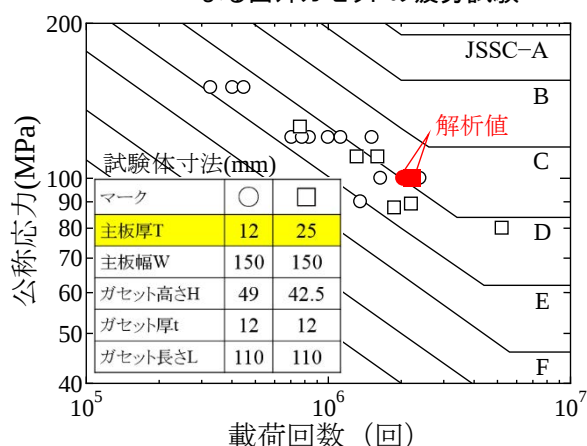
図-1 引張载荷における疲労強度
