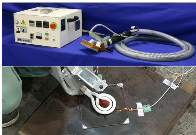
写真1 IH 処理装置 (上: 外観, 下: 作業状況)
