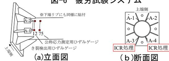
図-7 疲労試験におけるリブ部のひずみ測定位置
