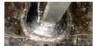
写真-2 処理部からの疲労き裂
