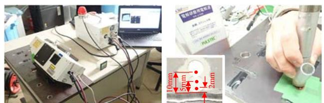
写真-1 X線残留応力計測の状況
