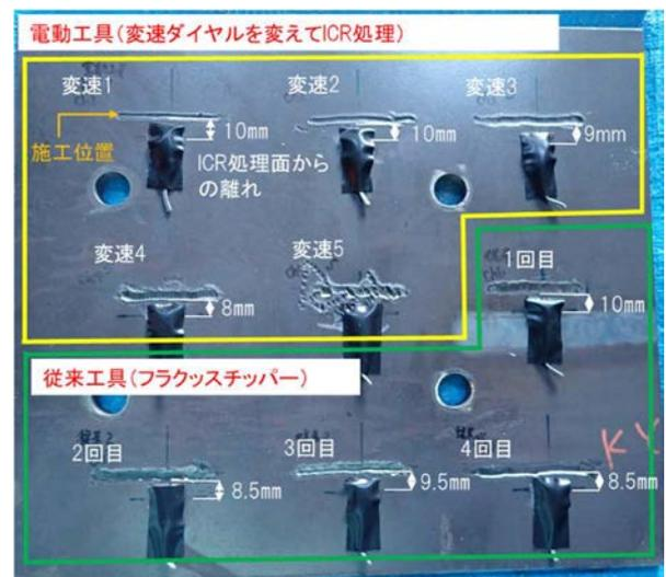
図-1 平板試験体を用いた ICR 処理状況
