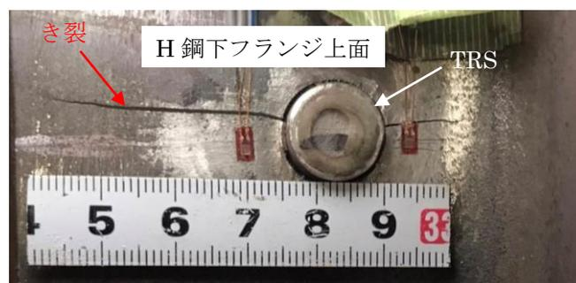
図-5 き裂発生状況(N=97 万回)
