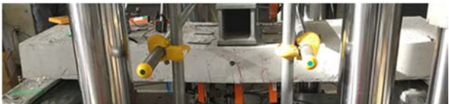
図-5 劣化床版の破壊状況
