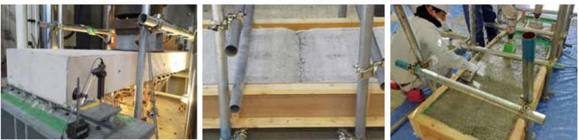
図-2 実験状況、破壊状況、上面増厚施工
