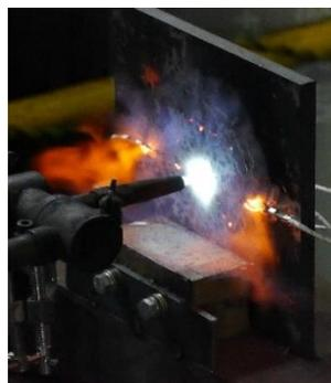
図-2 鋼板加熱実験の様子
