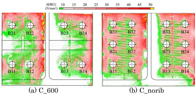
図2 ボルト締め付け後の接触圧分布
