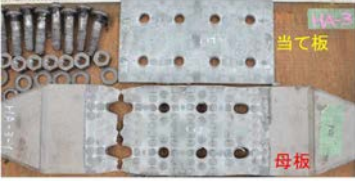
写真 1 試験後の解体写真 [H-28-200-a]
